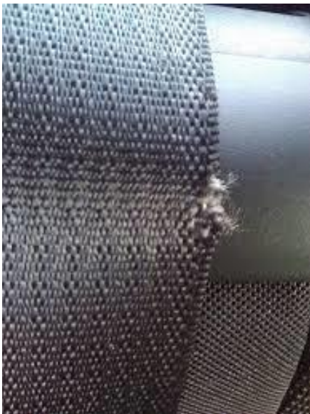
Edge damage (nick)
